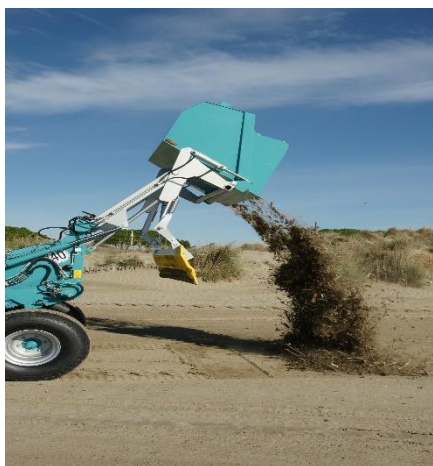
Общий объем бункера – 1,5 м 3 , высота при выгрузке – 2600 мм
